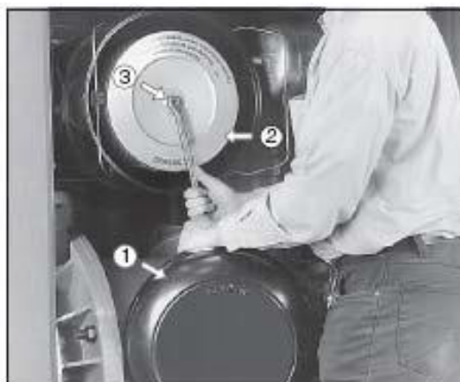
Рис. 5.2 Замена фильтрующего элемента воздухозаборника
