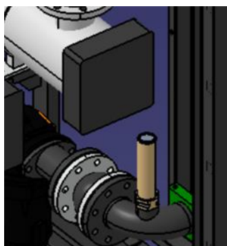
Рис. 5.10: Проверка предохранительного клапана (высокое давление).
